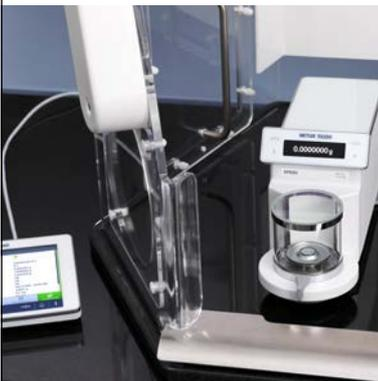
La microbalance XPR offre le plus faible encombrement du marché, ainsi que la possibilité de placer le terminal principal à l'endroit le plus accessible, même en dehors de l'enceinte de sécurité.
