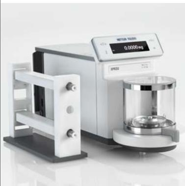
L'ioniseur autonome élimine l'électricité statique des échantillons et des conteneurs pour vous aider à relever le principal défi du micropesage.
