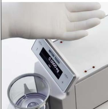
Les capteurs infrarouges SmartSens vous permettent d'actionner les portes du pare-brise d'un simple geste de la main. Cette utilisation mains libres de la balance réduit le risque de contamination croisée.
