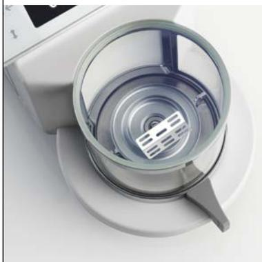
Ce support flexible permet de s'assurer que les échantillons tubulaires sont solidement maintenus sur la balance (p. ex. endoprothèses).
