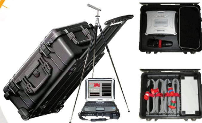
**LE SYSTÈME DE DÉTECTION DE PRÉSENCE MDS** A ÉTÉ CONÇU POUR DÉTECTER LES PERSONNES CACHÉES DANS LES VÉHICULES ET / OU LEUR CARGAISON. IL PEUT DÉTECTER N'IMPORTE QUEL MOUVEMENT GÉNÉRÉ PAR UNE PERSONNE DISSIMULÉE, EN CONTACT AVEC UNE SURFACE OU UN OBJET MÊME SI LE MOUVEMENT EST AUSSI FAIBLE QUE LES BATTEMENTS DU CŒUR HUMAIN. LE MDS PERÇOIT CES MOUVEMENTS GRÂCE À DES CAPTEURS SISMIQUES ET ANALYSE LES DONNÉES À L'AIDE D'ALGORITHMES AVANCÉS DE TRAITEMENT DU SIGNAL.
