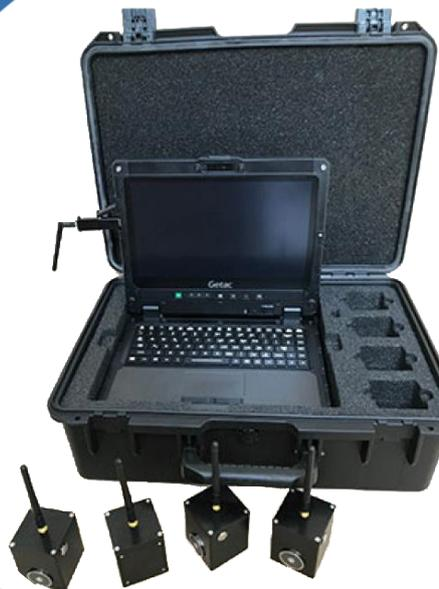
LE **CLANTECT MDT MOBILE** EST UN SYSTÈME DE DÉTECTION DE PRÉSENCE HUMAINE SANS FIL DE NOUVELLE GÉNÉRATION HAUTEMENT PORTABLE QUI FOURNIT UN SYSTÈME RAPIDE, TRÈS PRÉCIS, NON INTRUSIF POUR DÉTECTER LA PRÉSENCE HUMAINE CACHÉE DANS TOUT TYPE DE VÉHICULE ROUTIER.
