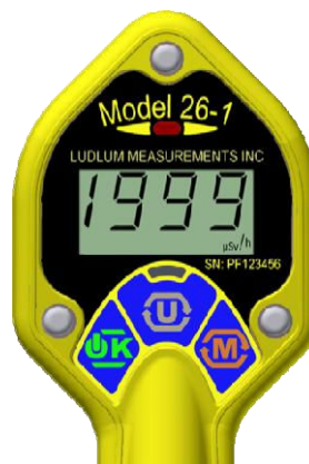
Figure 4: Dépassement de capacité (montré pour \mu\text{Sv/h} ); clignotant.
