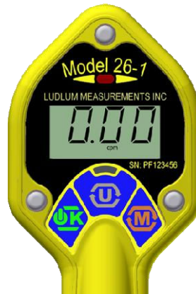
Figure 3: Affichage pour un défaut de détecteur, dans ce cas l'unité est cpm, affichage clignotant.
