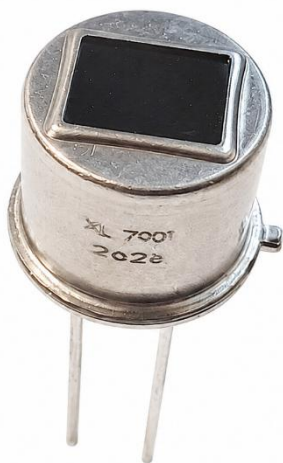
IMPM : Détecteur infrarouge de mouvement et de présence
